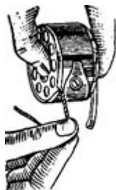
Притягивают нитку правой рукой через прорезь на краю колпачка налево под пружину натяжения, затем в небольшую прорезь на конце пружины. Свободный конец нитки должен свешиваться налево от установочного пальца колпачка.
