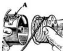
Намотанную шпульку нужно взять двумя пальцами правой руки, следя за тем, чтобы свободный конец нитки сбегал со шпульки справа налево. Шпульный колпачок держат левой рукой в таком положении, чтобы косая прорезь для нитки на краю колпачка оказалась сверху, и вставляют шпульку в колпачок.
