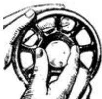
Рамку моталки, в которой вращается шпиндель с надетой шпулькой, отжимают рукой вниз, так чтобы резиновый обод шкива соприкасался с поверхностью маховика. Свободный конец нитки на шпульке некоторое время нужно придерживать рукой, пока на шпульку не намотается достаточное число витков для закрепления конца нитки, после чего этот конец
