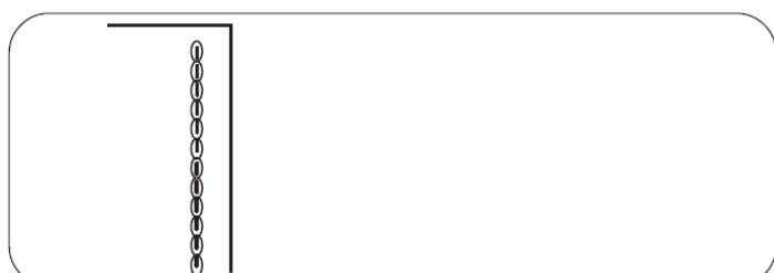
Этот крепкий эластичный стежок рекомендуется для придания ткани эластичности и крепости при ее растягивании. Используйте его для усиления области проймы и слоночных швов. Также используйте его на рюкзаках для придания большей прочности.
