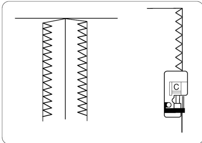
Это вариант зигзага при шитье одежды и при обработке краев.
